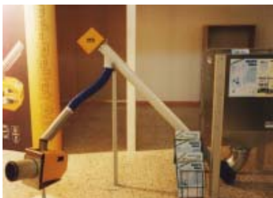
アレックス社のショールーム バーナー及び燃料タンクシステム
